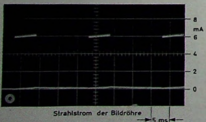
Bild 23. Schirmbildaufnahme eines 42 µs breiten Weißbalkens sowie Ströme und Spannungen an der PL 509 und der Bildröhre
